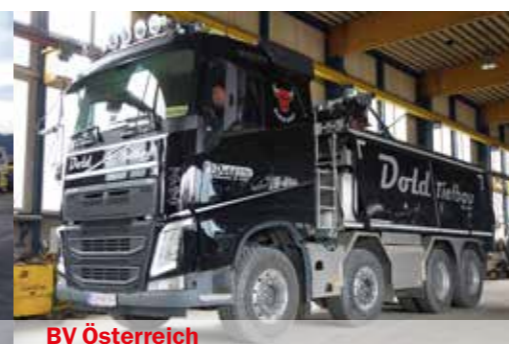
BV Österreich ASW 4729 - 4-Achser mit langem Führerhaus und kurzem Radstand
