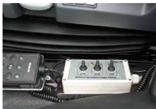
Auf Wunsch erhältlich: Bedienungseinheit neben dem Fahrersitz
