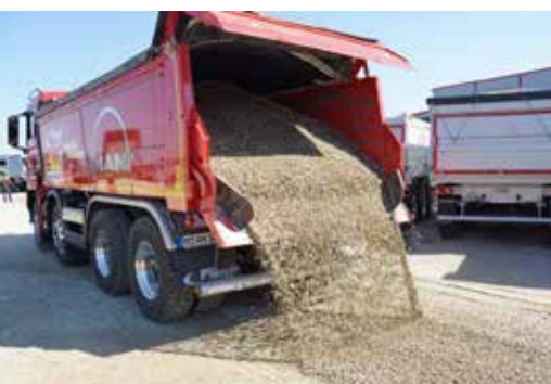
Sicheres „Ausziehen“ im Wege- und Straßenbau. Zentrierbleche mit ca. 2 m Streubreite
