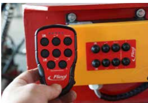
Pro Save-Steuerung mit Funk, Serie
