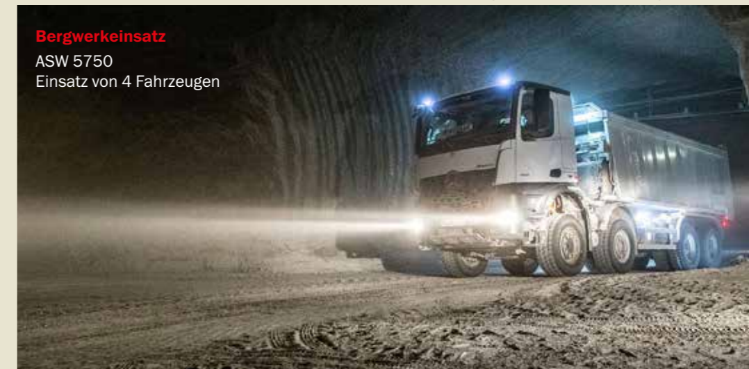
Bergwerk Teutschenthal Besonderheit: Komplette Demontage des Fahrzeuges für den Transport Untertage (ca. 550 m Tiefe) - ASW 5750 Achsausführung 1 + 3 ==> extrem wendig
