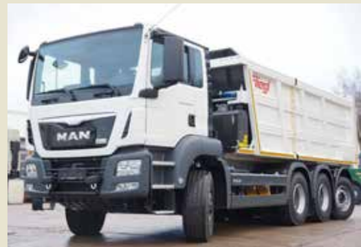
Bergwerk Teutschenthal Besonderheit: Komplette Demontage des Fahrzeuges für den Transport Untertage (ca. 550 m Tiefe) - ASW 5750 Achsausführung 1 + 3 ==> extrem wendig
