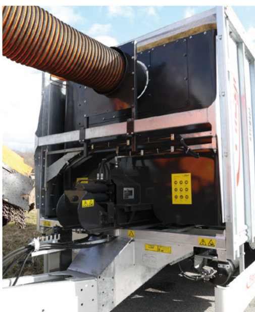
Abb. links: Einblasstutzen; Stabile Abdeckung aus abnehmbaren Lochblechsegmenten
