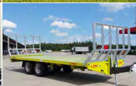
Tandem-Plattformwagen mit Ballensicherungsgitter und Sonderlackierung (optional)
