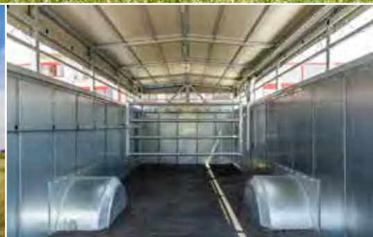
Verstellbares Trenngitter und Boden aus Riffelblech mit Abflussöffnung
