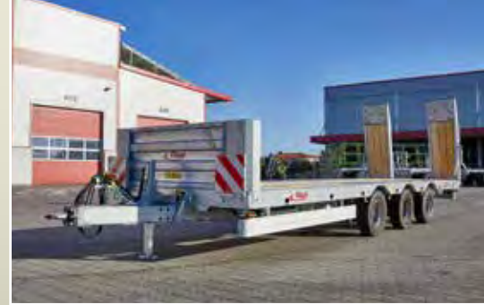
Der TPA 370 Stirnwand 800 mm in Serie Auffahrampen klappbar
