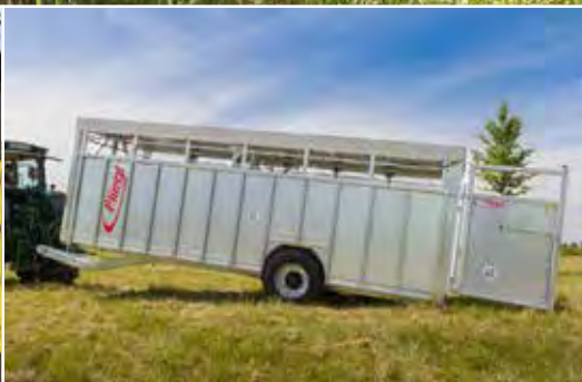
Hydraulische Hebeeinrichtung zum erleichterten Ein- und Ausstieg
