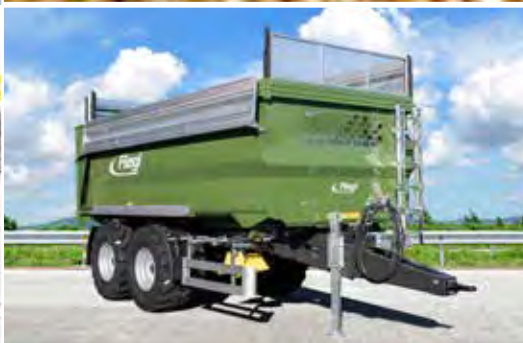
Verzinkter Aufbau, klappbar
