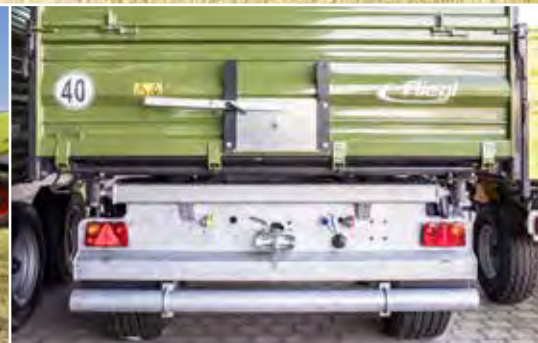
40 km/h Ausführung mit Unterfahrschutz und Kotflügel
