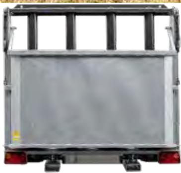
Optional: Streuwalzenschutz und Stauschieber beim ADS 60
