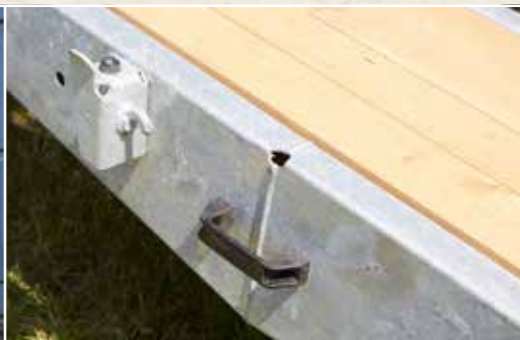
Auffahrampen mit Holz belegt, Brückenboden aus Stahlblech 3,5 mm lackiert beim TPA 120
