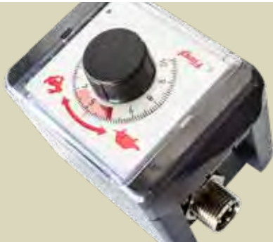
Elektrisches Potentiometer mit einstellbarer Vorschubgeschwindigkeit am Bedienpult
