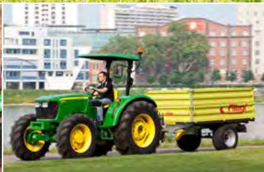
EDK mit Aufsatzbordwänden (auch nachrüstbar).
