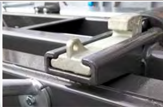
Umsteckbares Verriegelungssystem für Innen- und Aussenverriegelung
