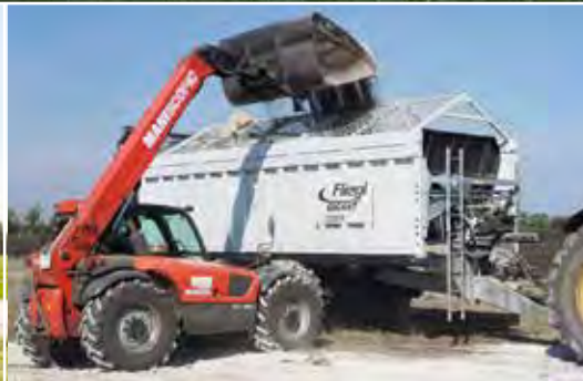
ASW 373 Tiger mit Schutzgitter gegen Fremdkörper
