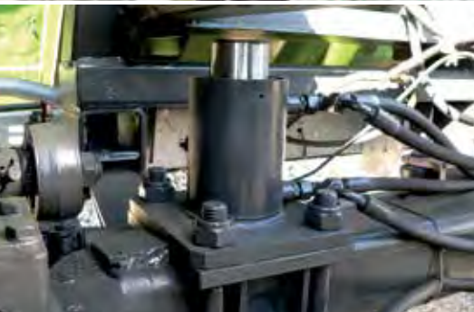
Optional: Hydraulische Abstützung auf die Achse
