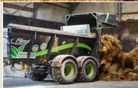
Der ADS ist optional mit Großraumrückwand 800mm umrüstbar und als Transportanhänger nutzbar
