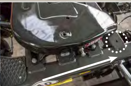
Mechanische Sattelplattenverstellung für Einachs- und Tandem-Dolly
