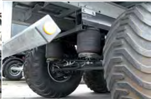
Optional: Luftfederung mit automatischer Kippabsenkung
