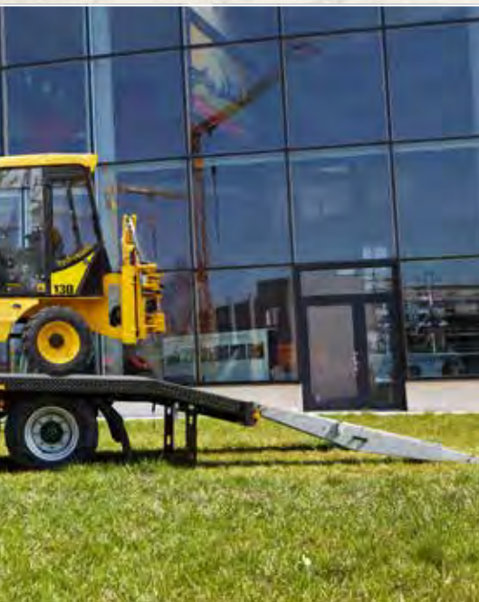
Auffahrampen mit Holz belegt, Brückenboden aus Stahlblech 3,5 mm lackiert beim TPA 120
