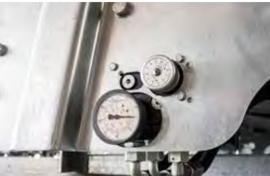
Mechanisches Potentiometer mit einstellbarer Vorschubgeschwindigkeit am Streuwerk
