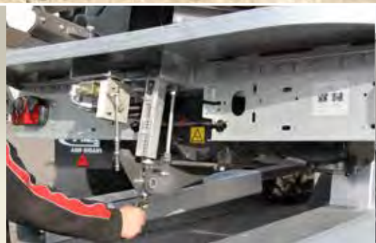
Über die automatische Vorschubregelung wird die Abschiebegeschwindigkeit angepasst
