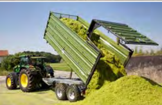
Silierkipper mit hydraulischer Rückwand
