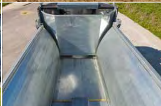
Geringster Verschleiß durch hydr. Schiebesystem – kein Kratzboden.
