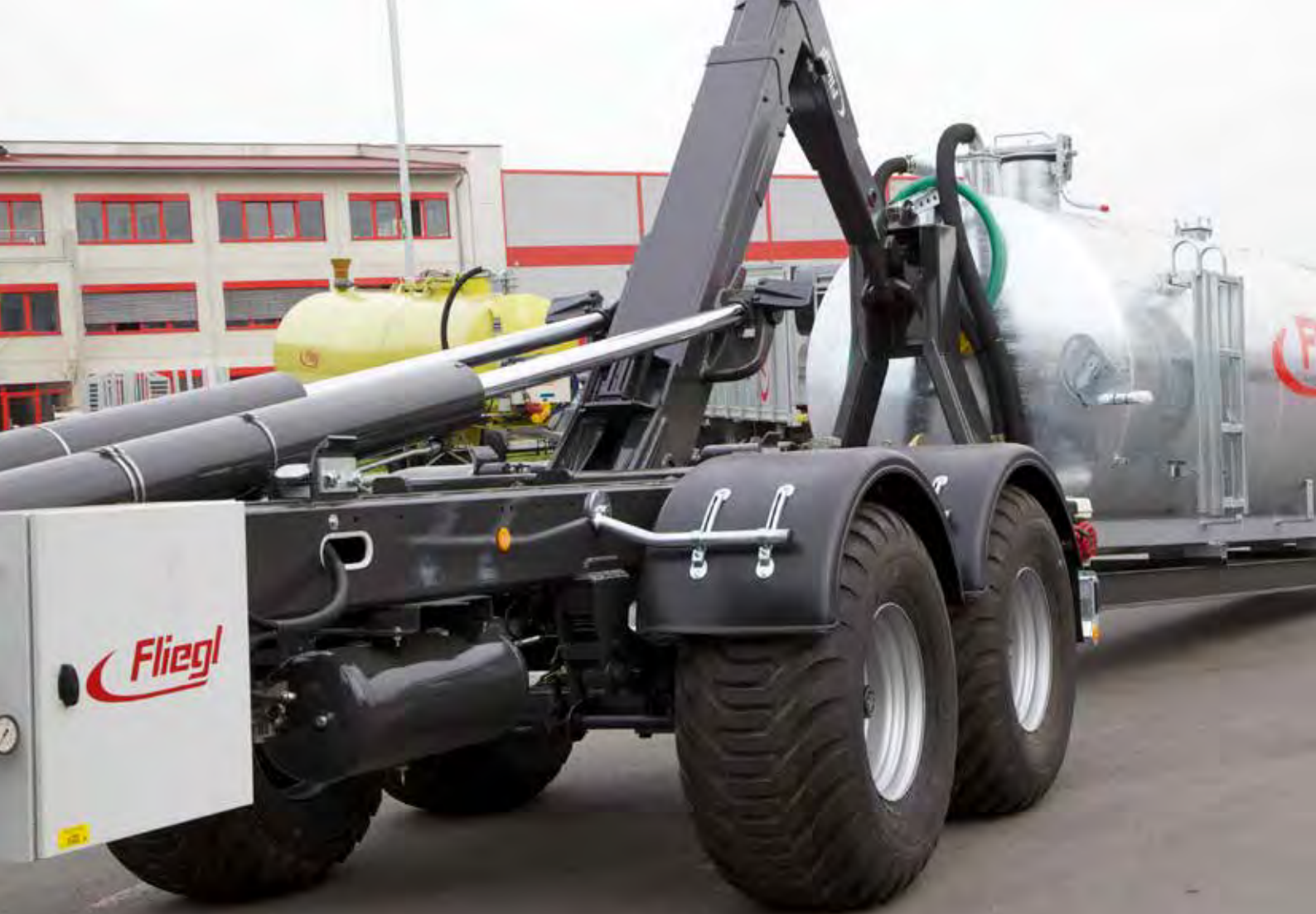
Geschmiedeter, einfach auswechselbarer Aufnahmehaken
