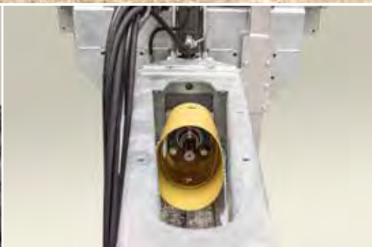
Über einen Zapfwelldurchtrieb wird das Streuwerk mechanisch angetrieben
