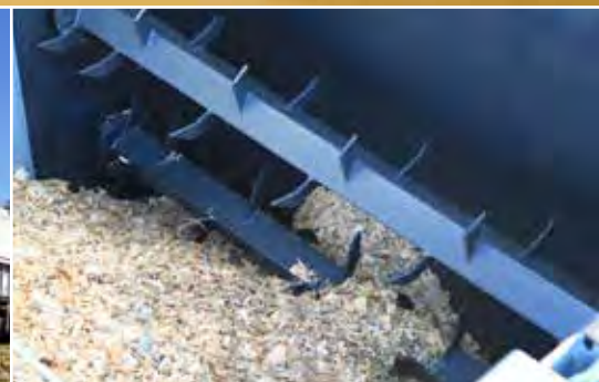
Fräsrollen sorgen für eine gleichmäßige Zuführung
