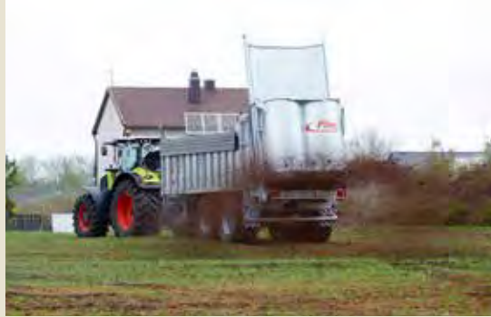
Streuwerk »Profi V2« mit geschlossener Breitstreurückwand
