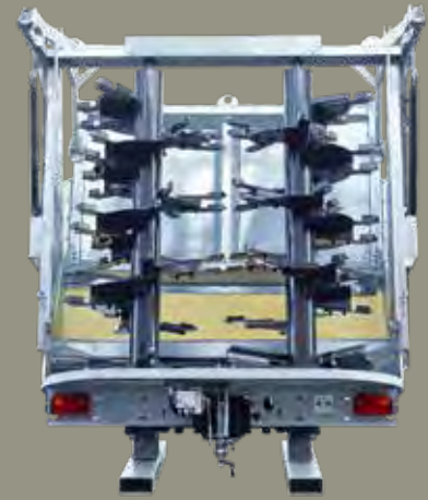
Fräswalzen mit Wurfschaufeln
