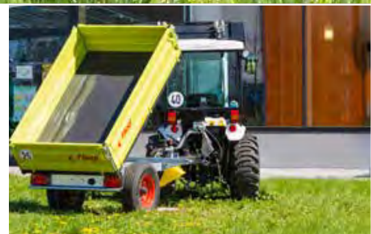
Einachs-Dreiseitenkipper für jede Schleppergröße passend
