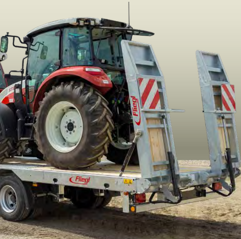
Der TPA 370 Stirnwand 800 mm in Serie Auffahrampen klappbar
