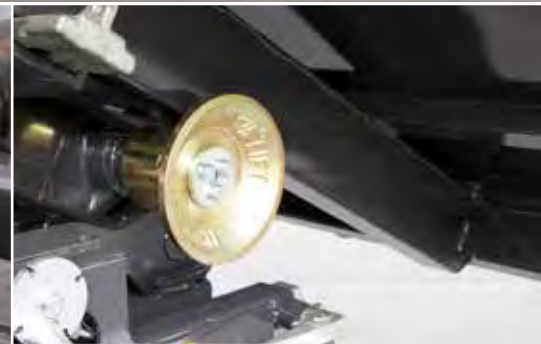
Große Stahlguss-Ablaufrollen ( \varnothing 310mm) mit großer Zentrierschräge erleichtern das Aufziehen des Containers.
