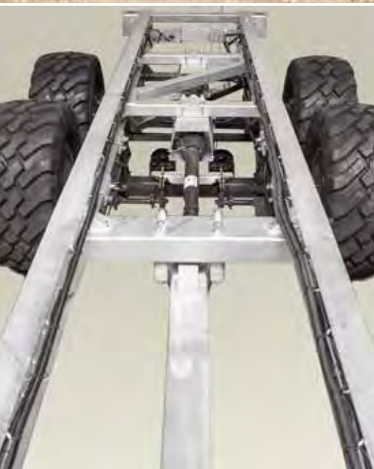
Über einen Zapfwelldurchtrieb wird das Streuwerk mechanisch angetrieben
