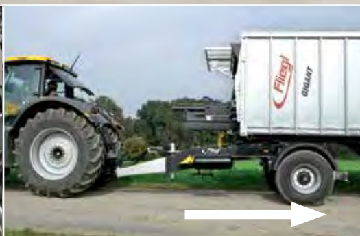
Hydraulische Sattelplattenverschiebung für Einachs- und Tandem-Dolly
