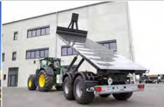
HKL22 mit Platformaufbau
